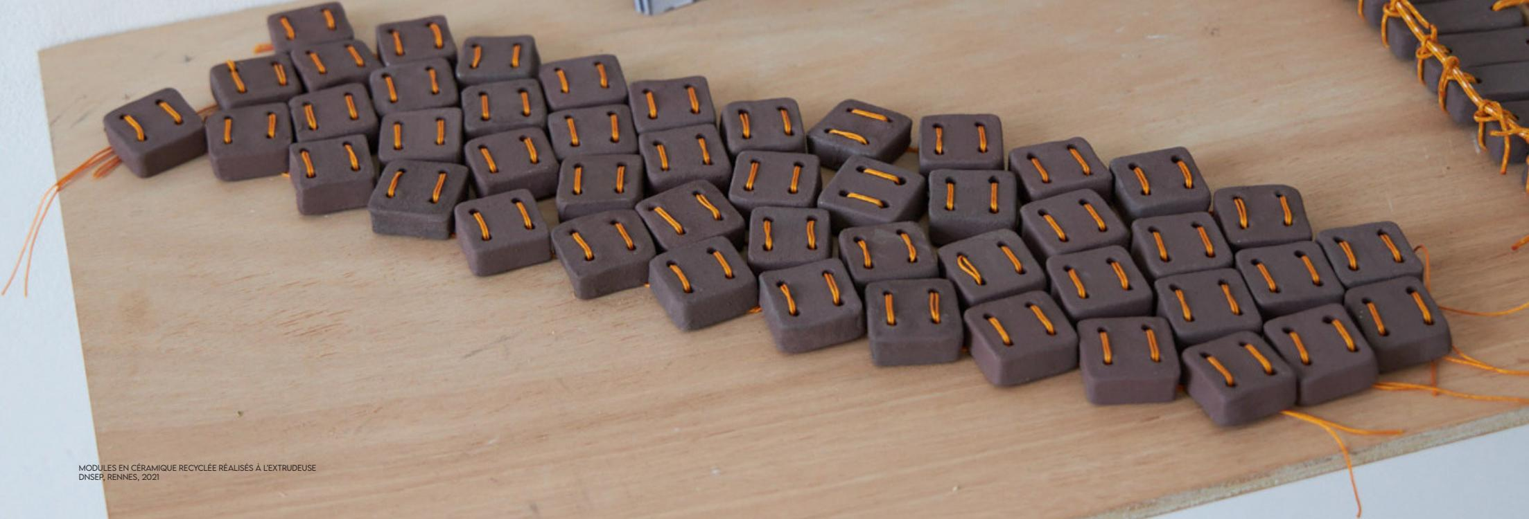
MODULES EN CÉRAMIQUE RECYCLÉE RÉALISÉS À L'EXTRUDEUSE
